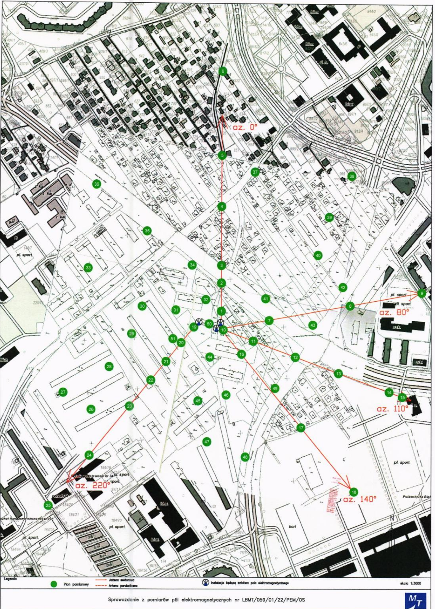
Rys.1 Lokalizacja pionów pomiarowych
