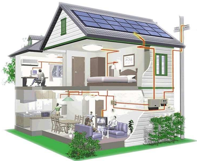
Rys. 22. Przykład domowej instalacji fotowoltaicznej (Źródło: https://pvgroup.pl/ )
