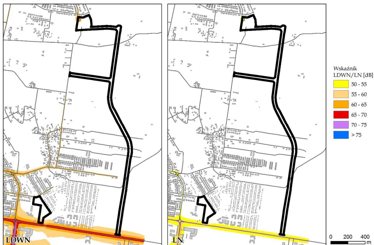
Rysunek 5 Imisja hałasu komunikacyjnego L_{DWN} i L_N w obszarze projektu zmiany planu źródło: Mapa akustyczna miasta Białystok, 2017 r.
